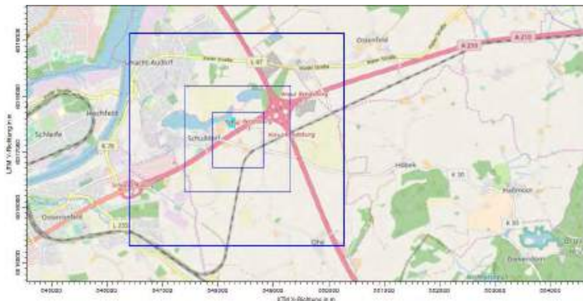
Abbildung 6.8: Rechengitter Rechenzellgröße 8 m / 16 m / 32 m
